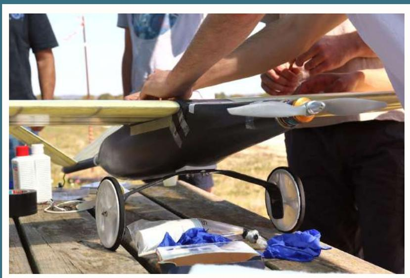
Durante este processo demorado de montagem antes do teste de voo nada é alterado na aeronave. É seguido o plano previamente delimitado para o carregamento da aeronave, que pode variar entre voos. São também seguidas check-lists, tanto de montagem como de requerimentos pré-voo, que evitam erros durante esta fase de preparação.
