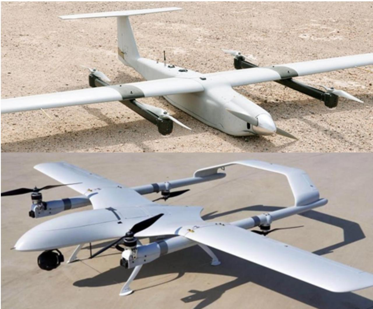
VTOL com motores distintos para voo vertical (Arcturus UAV T-20) e horizontal vs VTOL com motores com orientação variável (VQ100)
